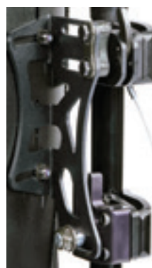
Encaixes de 4 pontos (5 cms de ajuste)
