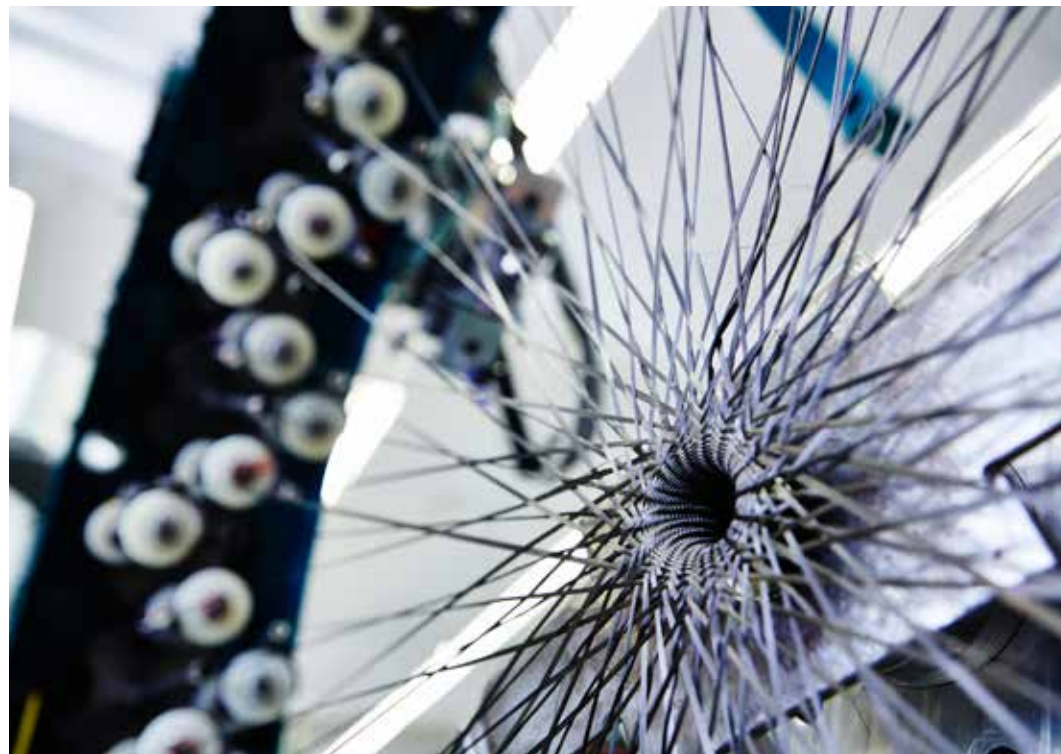
Processo de trançado dos filamentos de carbono realizado por robots para confeccionar os tubos da estrutura da Krypton.
